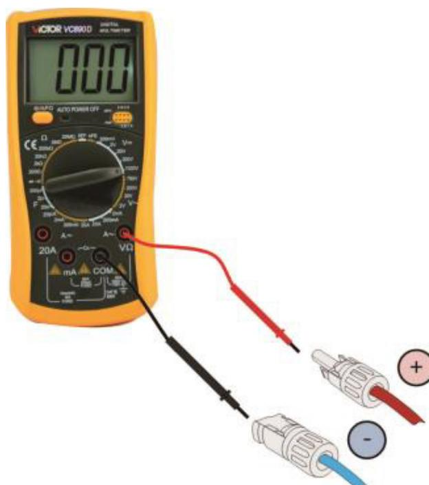
Compruebe la polaridad positiva y negativa de las cadenas fotovoltaicas y conecte los conectores fotovoltaicos a los terminales correctos. Se pueden producir daños graves en el inversor y en el conector (debido a la temperatura).
