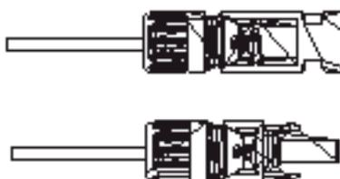
Figura 4.11 Conector con tuerca ciega atornillada
